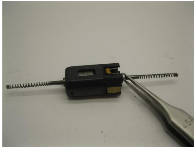
Entfernen Sie die Federn vorsichtig mit einer Pinzette Carefully remove the springs with tweezers Verwijder de veren voorzichtig met een pincet
